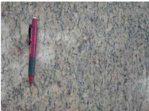
**Foto 4.7-** Detalhe da textura do granito porfirítico da Suíte Aimorés comercializado com o nome “Granito Giallo Latina” (Distrito de Cotaxé, município de Ecoporanga).
