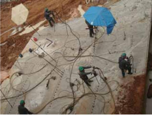
**Foto 6.10** – Esquadrejamento de prancha por meio de marleteles pneumáticos manuais, município de Vila Pavão.
