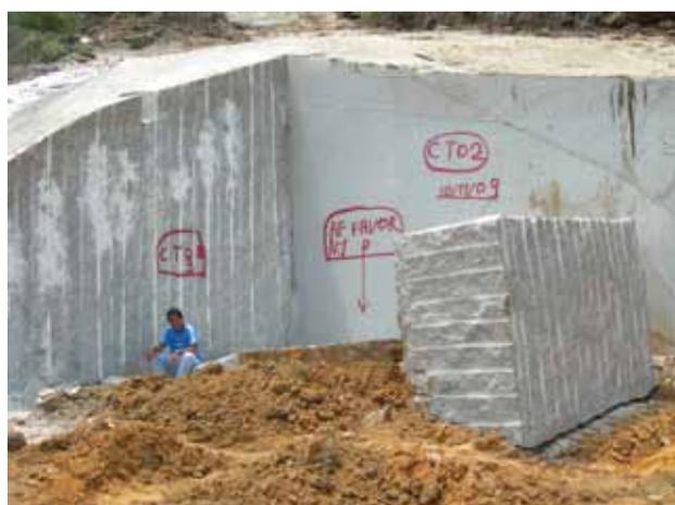
**Foto 6.7** – Dois tipos de cortes: a direita realizada com fio diamantado, e a esquerda, face de corte através de perfuração descontínua combinada com argamassa expansiva (resíduos brancos nas calhas dos furos).
