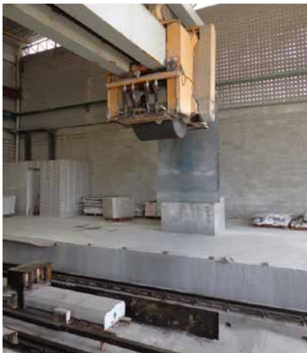
Foto 6.20 – Talha-blocos utilizado para corte vertical e produção de lajotas padronizadas.
