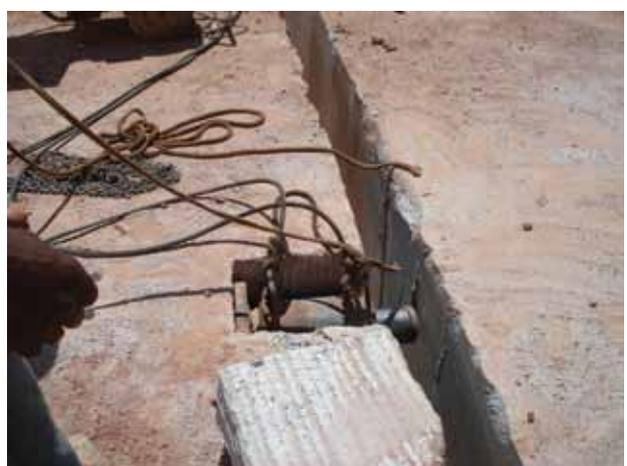
**Foto 6.14** – Técnicas utilizadas para tombamento de prancha por meio de macaco hidráulico, município de Ecoporanga.
