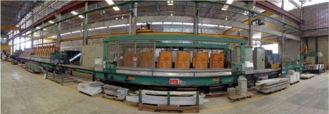
**Foto 6.22** – Linha completa de produção de ladrilhos, onde se visualiza na posição frontal a máquina calibradora e a esquerda a politriz de tiras, seguida do restante dos equipamentos.
