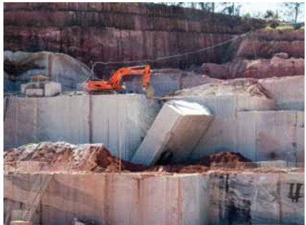
**Foto 6.13** – Técnicas utilizadas para tombamento de prancha através de retroescavadeira no município de Baixo Guandu. Notar na foto, colchão de detritos para amortecimento do painel vertical.
