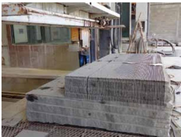
Foto 6.21 – Equipamento tipo talha-blocos empregado no corte horizontal das tiras do bloco processado.
