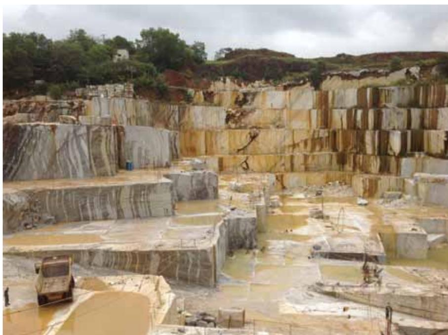
**Foto 3.2** – Frente de lavra em maciço, através do sistema de bancadas. Na porção frontal, observa-se a foliação e o baixo nível de fraturas da rocha.
