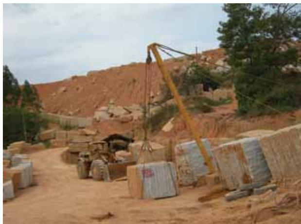
**Foto 6.16** – Alçamento por cabos de aço para carregamento em caminhão.
