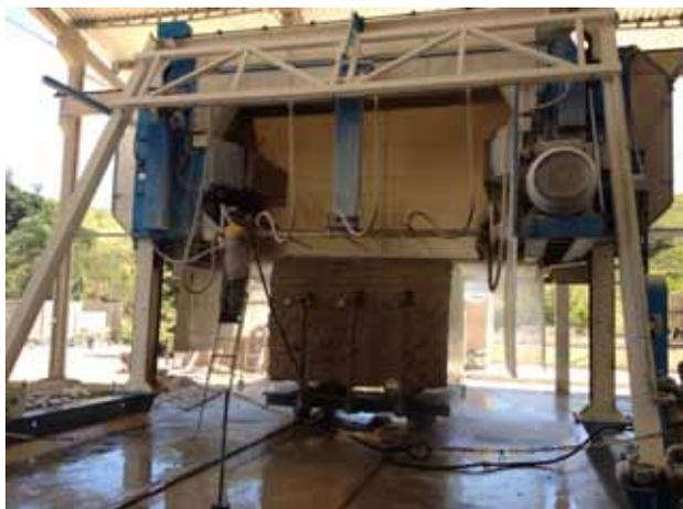
Foto 6.19 – Corte de chapas através de tear multifio diamantado.
