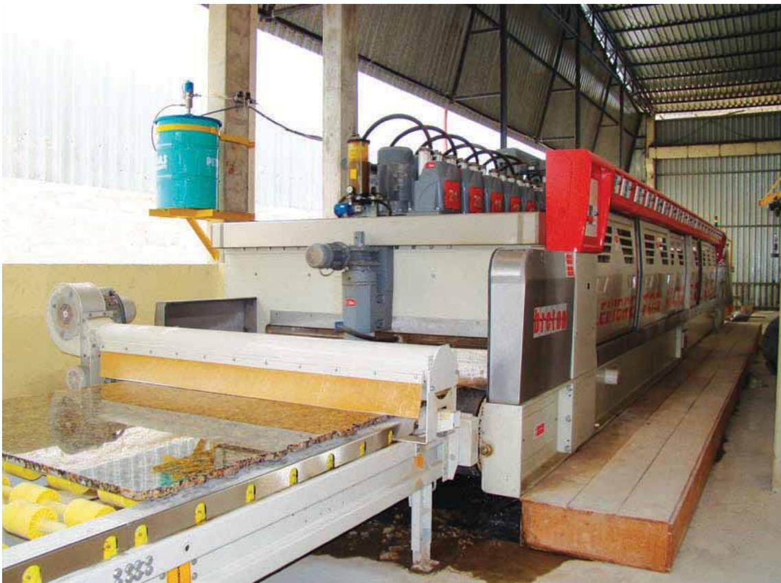
**Foto 6.23** – Politriz multicabeças automática utilizada no polimento de chapas.
