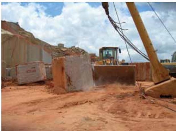
**Foto 6.15** – Procedimentos de embarque de blocos. Arrasto de bloco por pá carregadeira até o “pau de carga”.
