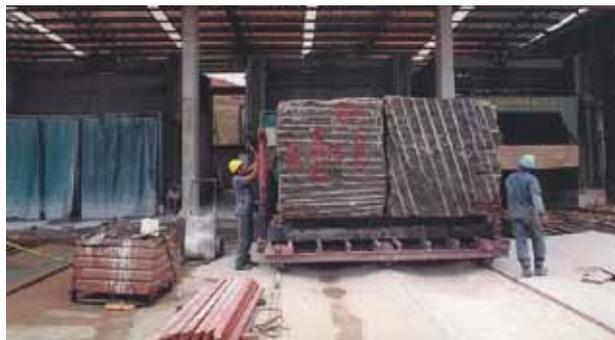
**Foto 6.18** – Preparação de um tear multilaminas, destacando o correto posicionamento dos blocos.
