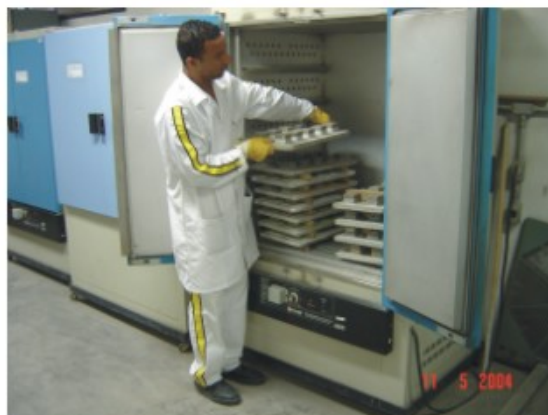
Foto 64 - Cura em estufa de corpos-de-prova, para ensaios de arrancamento, que simulam ambientes externos sujeitos à insolação.
