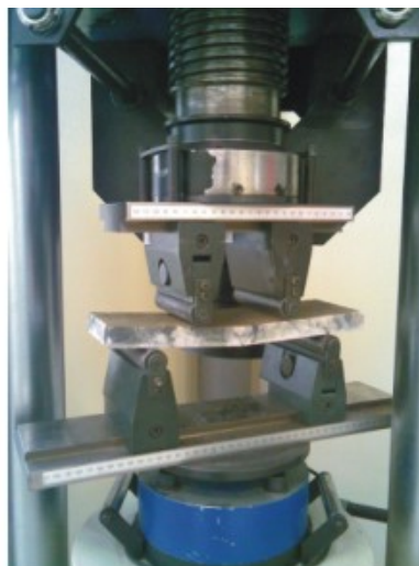
Foto 62 - Ensaio de resistência à flexão com quatro apoios (norma ASTM-C880).
