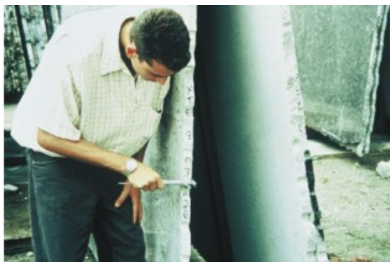
Foto 97 - Controle de espessura de chapa de rocha, utilizando-se paquímetro.
