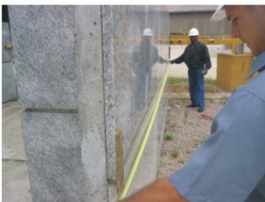
Foto 100 - Avaliação da presença de empenamento em uma peça grande de material granítico.
