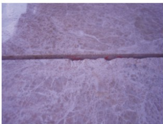
Foto 99 - Peças de mármore com arestas quebradas, não qualificadas para utilização em revestimento.
