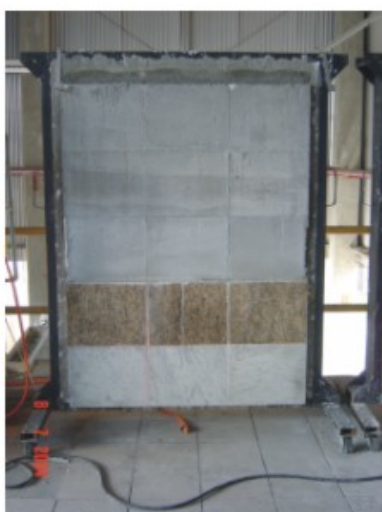
Foto 81 - Resultado do teste da foto 83, observando-se deslocamento das placas assentadas com argamassas cimentícias convencionais.
