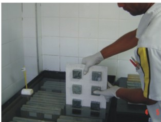
Foto 63 - Cura submersa de corpos-de-prova, para ensaios de arrancamento, que simulam ambientes úmidos ou constantemente molhados.
