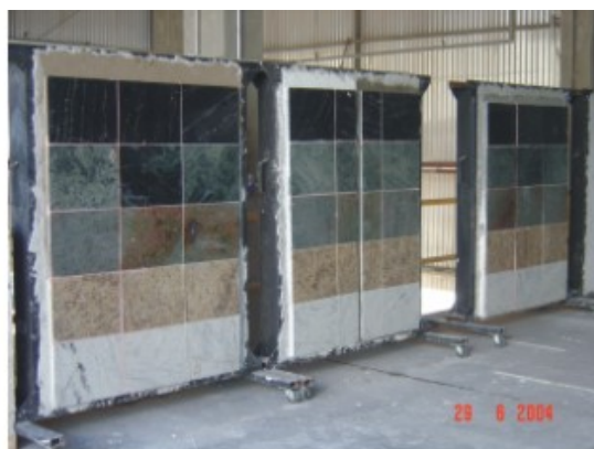
Foto 80 - Assentamento de rochas com diversas argamassas, em painel vertical de concreto, para avaliação do risco de patologias (deslocamento, manchamento, eflorescência, escamações) em paredes e fachadas.
