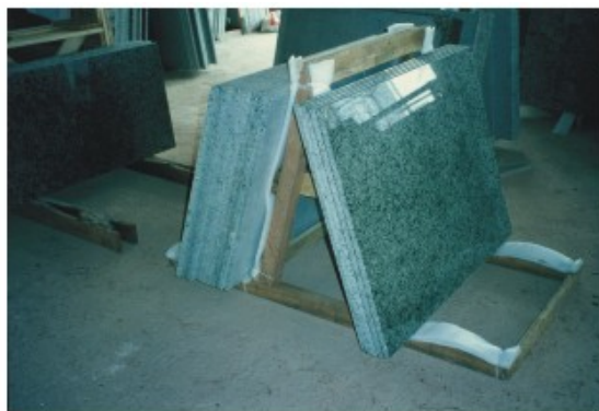
Foto 104 - Placas rochosas armazenadas sobre cavalete de madeira, envolvido por material impermeável (polipropileno expandido).
