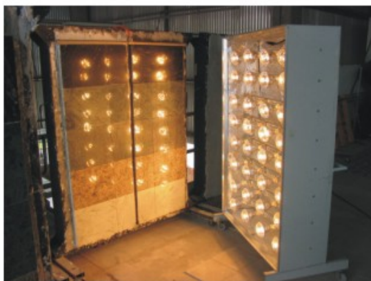
Foto 82 - Teste de patologias em fachadas e paredes, com equipamento que simula os efeitos de insolação.
