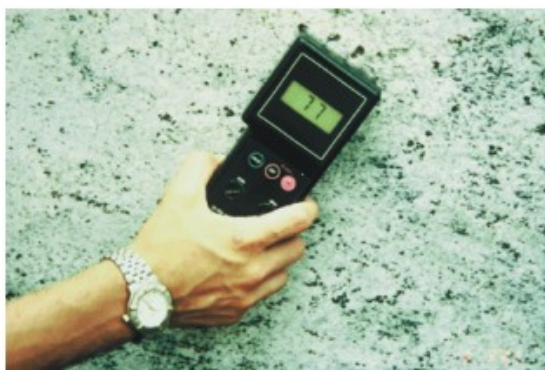
Foto 98 - Controle do nível de lustro/brilho em chapa polida de granito (77 pontos registrados no Gloss Checker).
