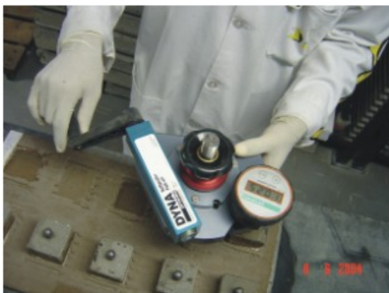
Foto 65 - Ensaio de resistência ao arrancamento, para argamassas e granitos diversos, utilizando-se substrato padrão de concreto e medição com dinamômetro.
