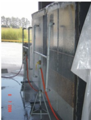
Foto 83 - Teste de patologias em fachadas e paredes, com equipamento que simula a ação de chuvas.
